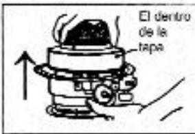
11. Ponga una mecha nueva y inserte los 3 alfileres en una nueva mecha en los 3 agujeros en el manguito de la mecha hacia arriba. (Véase el marcado "↑" en el manguito de la mecha)
