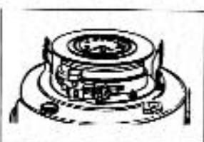
7. Quite las cuatro tuercas de mariposa que mantiene el montaje de la mecha junto al calentador y cuidadosamente levante el montaje de la mecha del calentador.
